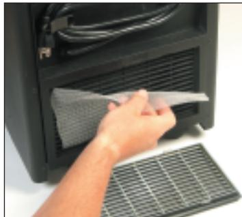
2. Ponga agua caliente sobre el filtro, en la dirección opuesta al paso del aire, para limpiar el polvo y suciedad hasta que el agua aparezca transparente otra vez. Tener cuidado al limpiar el filtro ya que puede estar sucio y desprender sustancias en áreas no deseadas como moquetas. Si se desea se puede limpiar el filtro con una pequeña cantidad de jabón suave (no se olvide de aclarar el filtro si utiliza jabón).
